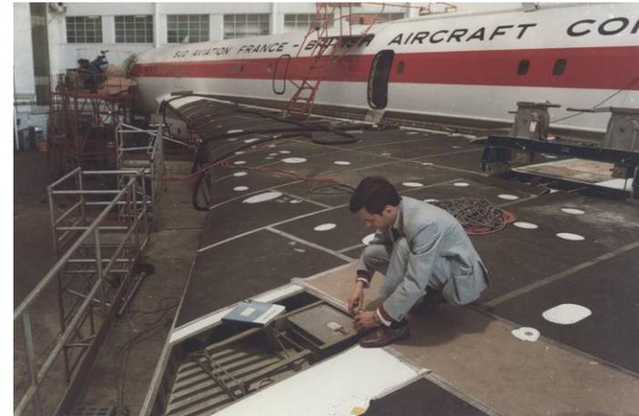
Impulseurs à propergol solide sur aile de Concorde
