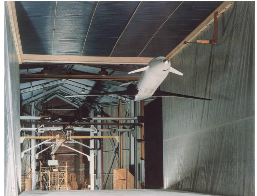
Essai d'une maquette d'avion d'affaires TGA
