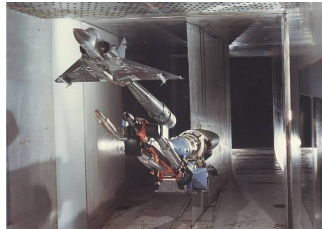
ASMP sous Mirage 2000 dans S2MA (1978)
